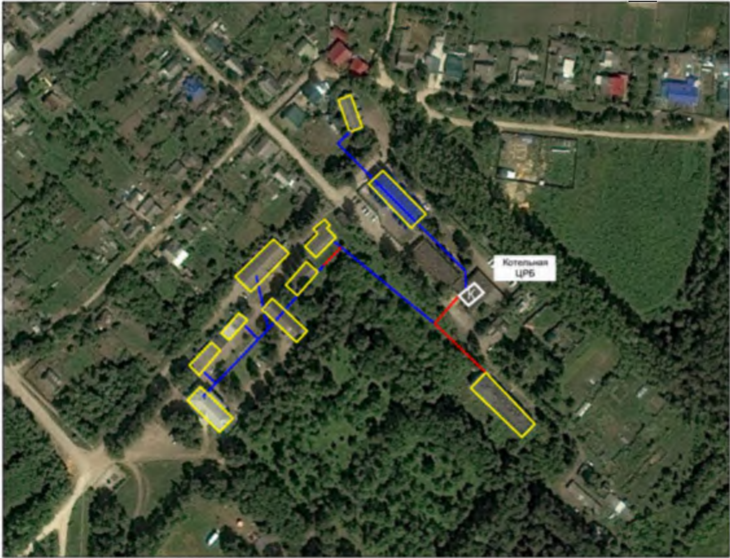
Схема теплоснабжения котельной ЦРБ г. Новосиль
